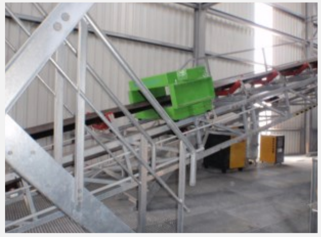
Förderbandmagnet und Suchgeräte zur Entfernung von Eisenteilen in den Produkten.
