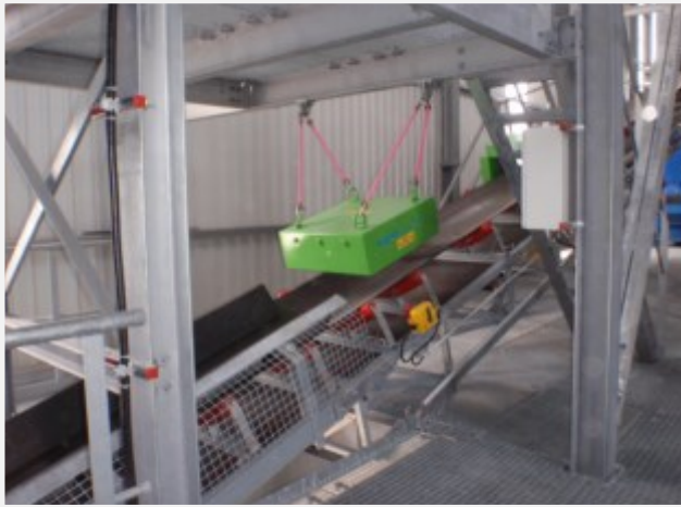
Förderbandmagnet und Suchgeräte zur Entfernung von Eisenteilen in den Produkten.
